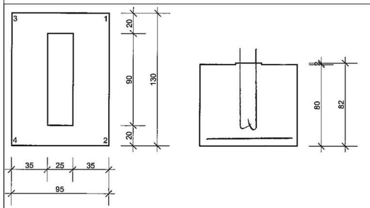
Die Pylone werden mittels Ankerstangen und Injektionsmörtel
