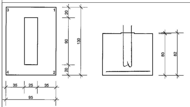
Die Pylone werden mittels Ankerstangen und Injektionsmörtel
