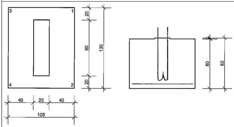
Die Pylone werden mittels Ankerstangen und Injektionsmörtel
