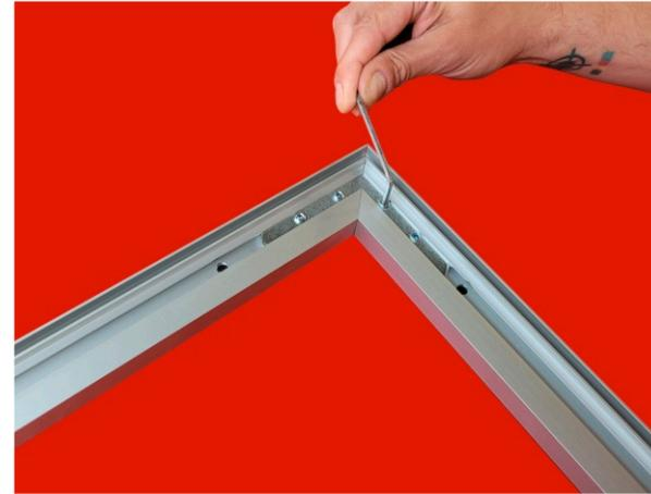
Das Profil auf den Eckwinkel schieben und die Inbus-Wurmschrauben festziehen.
