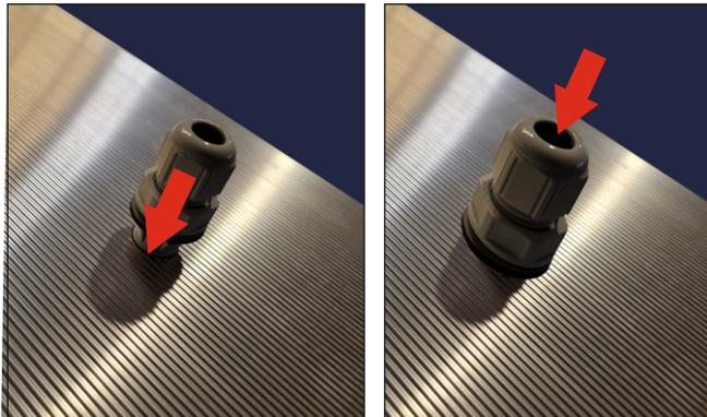
Pressverschraubung in die ausgewählte Bohrung drücken bis sie einrastet und untere Mutter festziehen (Linksgewinde!) 230V Anschlussleitung durch die Pressverschraubung führen.
