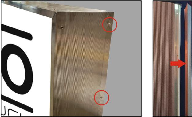
Schrauben an der Stirnseite des Rahmens aufdrehen und Rahmenteil entfernen. **Bei Schildern mit 17 und 23 cm Bautiefe wird nur eine Leiste entfernt, bei 10 cm tiefen Schildern wird der komplette stirnseitige Rahmenteil entfernt.**
